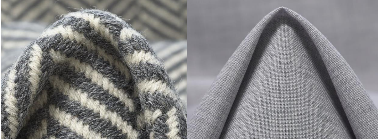
Fotoğraf 5: Straygharn İplikten İmal Edilen Kumaş Yüzeyi (Solda), Kamgarn İplikten İmal Edilen Kumaş Yüzeyi (Sağda)
